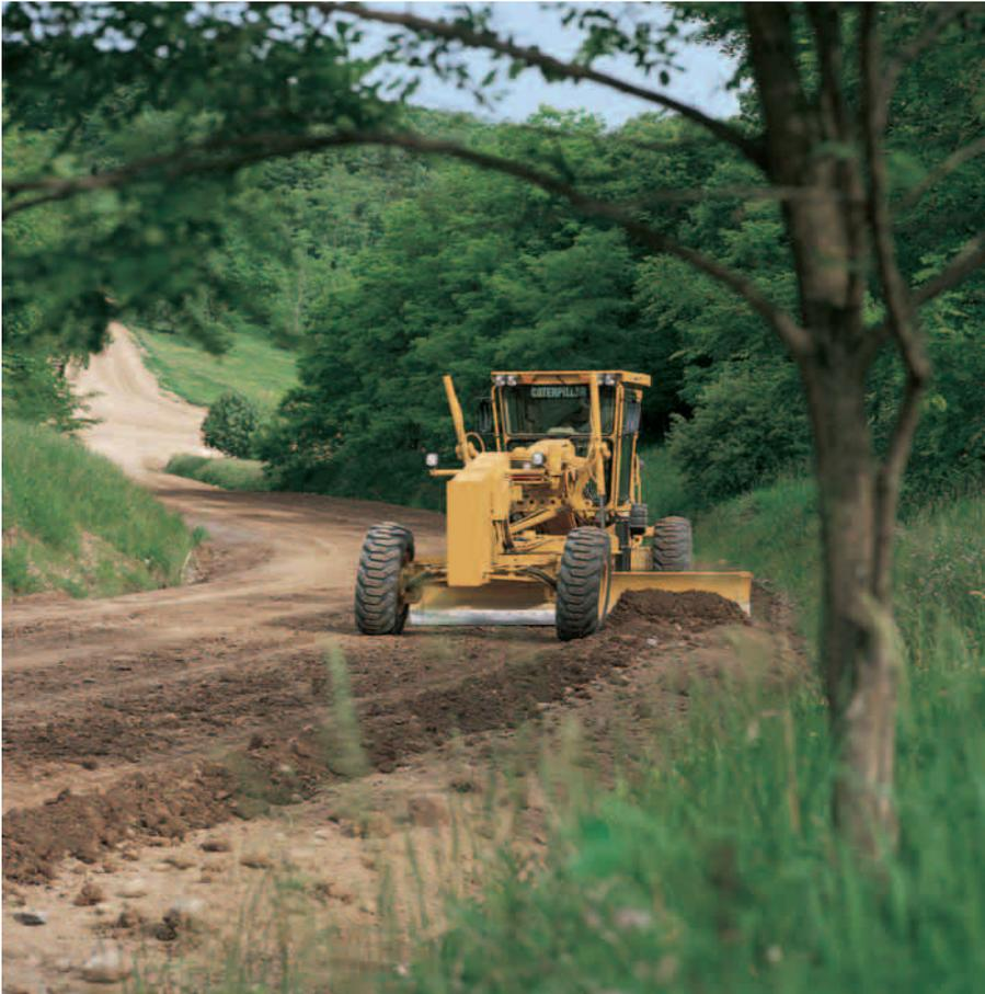
**Cabine silencieuse.** Le montage du moteur et de la transmission sur amortisseurs atténue le bruit du moteur et les vibrations à l'intérieur à moins de 75 dB(A). Grâce à l'ensemble d'insonorisation, les niveaux de pression acoustique mesurés suivant la norme ISO 6394 ne dépassent pas 72 dB(A). Cet environnement silencieux aide le conducteur à rester alerte et concentré.
