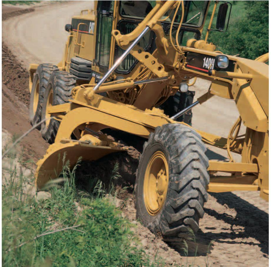
**Embrayage à glissement d'entraînement de cercle.** Cette caractéristique de série protège les pièces de la barre d'attelage, du cercle et du bouclier des contraintes dues au choc quand la lame heurte un obstacle. Elle contribue à empêcher la niveleuse de changer brusquement de direction en conditions d'adhérence médiocre.
